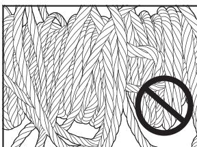
Stellen Sie sicher, dass das Seil gleichmäßig auf der Trommel aufgewickelt ist. Ein spiralenförmig aufgewickeltes Seil wird leicht beschädigt und hat eine kürzere Lebensdauer
